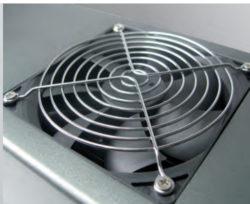
▼ Système Intelligent de régulation de la température par un ventilateur assisté à ultra-faible bruit.
