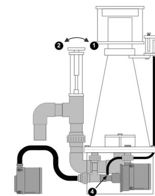
1. Pour obtenir une écume sèche, tournez la vanne micro ajustable dans le sens des aiguilles d'une montre.
