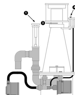
1. Ouvrez la vanne micro ajustable complètement (sens des aiguilles d'une montre) et démarrez la pompe d'alimentation.
