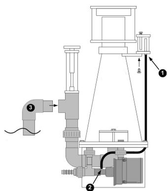
1. Assemblez le silencieux de prise d'air et raccordez le tube d'arrivée d'air comme indiqué sur le schéma.
